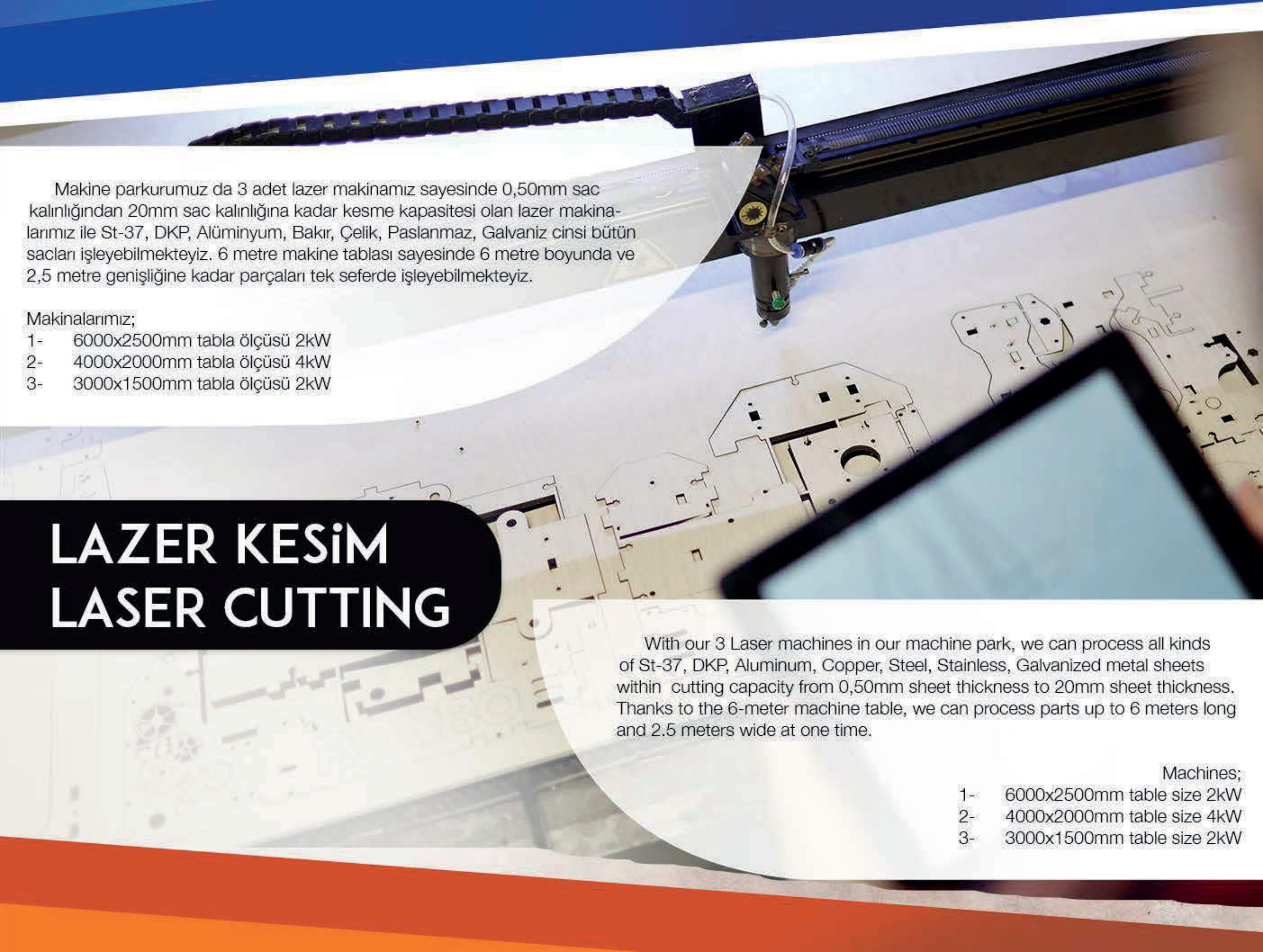
Makine parkumuz da 3 adet lazer makinamız sayesinde 0,50mm sac kalınlığından 20mm sac kalınlığına kadar kesme kapasitesi olan lazer makinalarımız ile St-37, DKP, Alüminyum, Bakır, Çelik, Paslanmaz, Galvaniz cinsi bütün sacları işleyebilmekteyiz. 6 metre makine tablası sayesinde 6 metre boyunda ve 2,5 metre genişliğine kadar parçaları tek seferde işleyebilmekteyiz.
