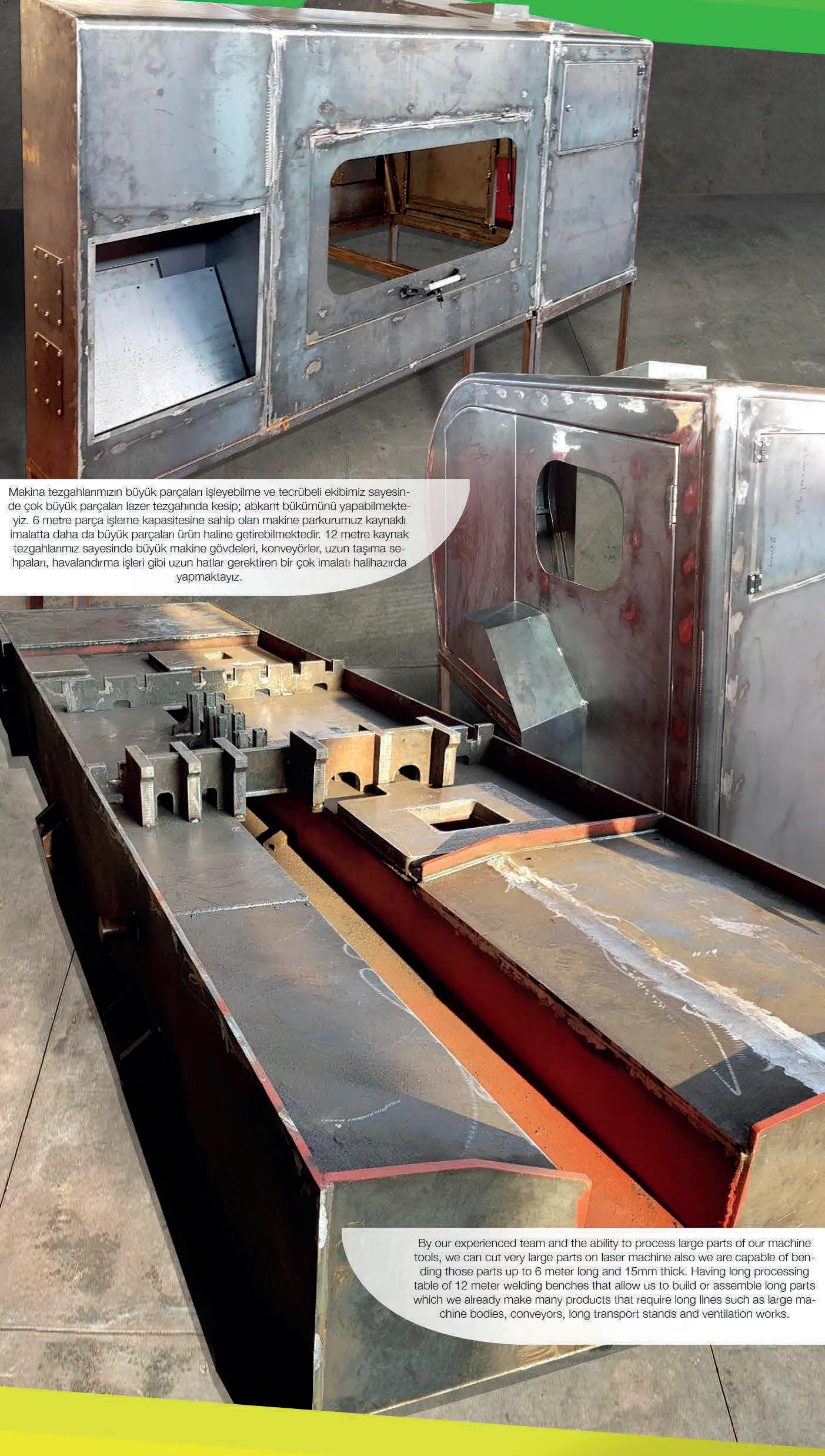
Makina tezgahlarımızın büyük parçaları işleyebilme ve tecrübeli ekibimiz sayesinde çok büyük parçaları lazer tezgahında kesip; abkant büükümünü yapabilmekteyiz. 6 metre parça işleme kapasitesine sahip olan makine parkurumuz kaynaklı imalatta daha da büyük parçaları ürün haline getirebilmektedir. 12 metre kaynak tezgahlarımız sayesinde büyük makine gövdeleri, konveyörler, uzun taşıma sehpaları, havalandırma işleri gibi uzun hatlar gerektiren bir çok imalatı halihazırda yapmaktadır.
